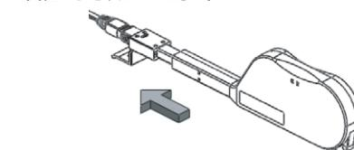
※押し込み時に、過大な力、矢印方向以外への力を加えないでください。
