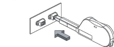
※押し込み時に、過大な力、矢印方向以外への力を加えないでください。
