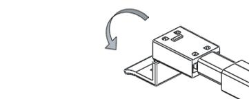
②アダプタとガイドのキーを合わせてください。ガイドをアダプタに対し真直ぐ挿入し、清掃布または挿入確認マークが完全に隠れるまで押し込みます。
