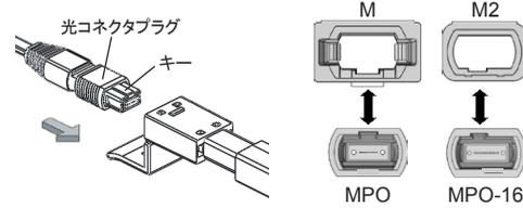
③アダプタに対し、メインボディを真直ぐ押し込みます。カチッと音が鳴ったら、クリーニング終了です。押し込みを止めて真直ぐ引き戻してください。
