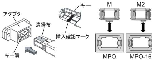
②アタッチメントと光コネクタプラグのキーを合わせてください。プラグをアタッチメントに対し真直ぐ挿入し、キーが隠れるまで押し込みます。
