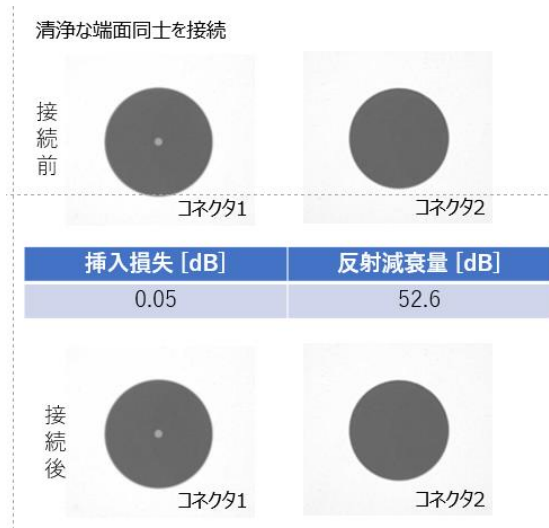
図 17 汚れない光コネクタ同士を接続した際の端面状態と光学特性
